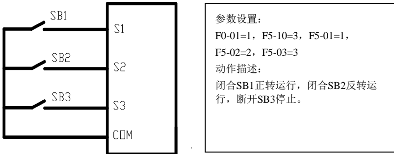
图 4-5 三线制端子启停控制方式举例
