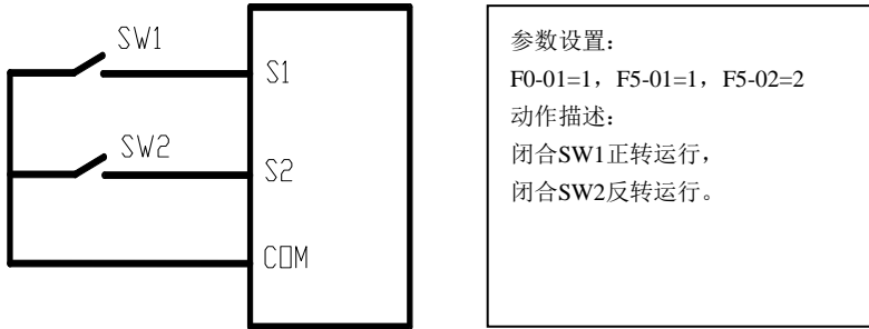
图 4-4 两线制端子启停控制方式举例
