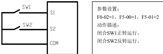
图4-4 两线制端子启停控制方式举例
